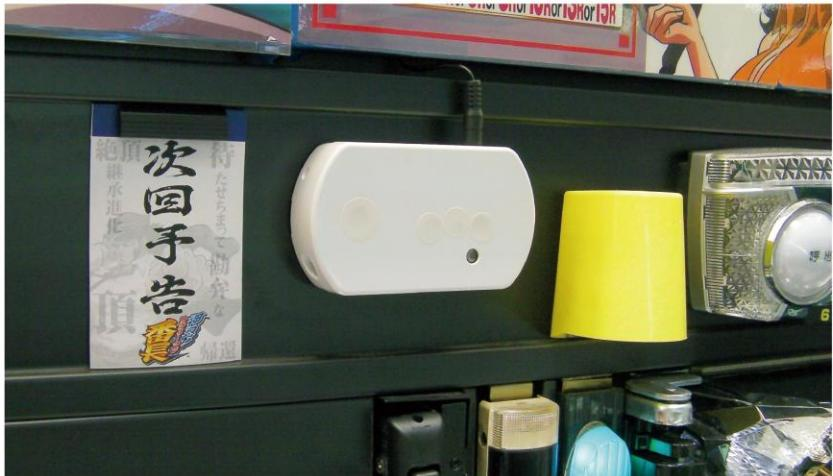
「エアラート」は子機にあたる小型センサーと親機（1台）で構成。センサー設置の目安は、500台規模の店舗で8台。また、センサーは妻板や幕板に両面テープで設置できる軽量設計。検知した情報は無線LANで親機へ中継されるため、大掛かりな工事の必要がない。なお、センサーの色は白・黒・黄・オレンジ・ブルーの5色
